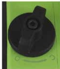
JOONIS 6: Gaasiballast näidatud "avatud" asendis
