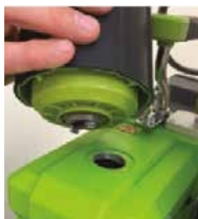
JOONIS 7: uudeemaldaja eemaldatud, näitab õliava
